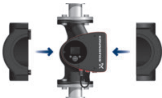
Рис. 60 Установка теплоизоляционного кожуха на насос MAGNA3
